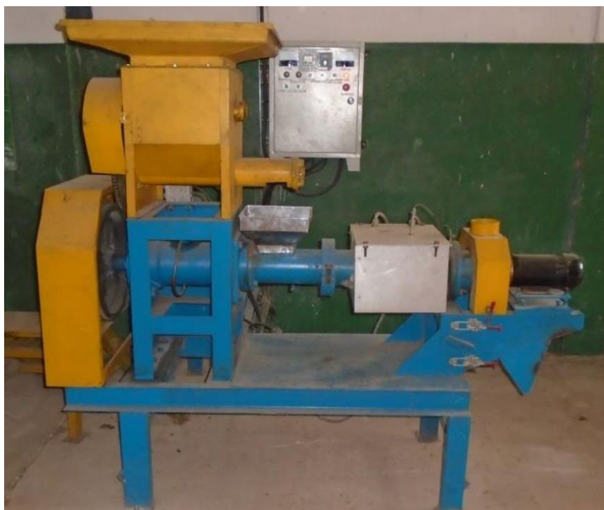
Photo 2 : Présentation de l'extrudeur monovis utilisé à la Société Agro-Piscicole de la Mé (SAP Mé)
