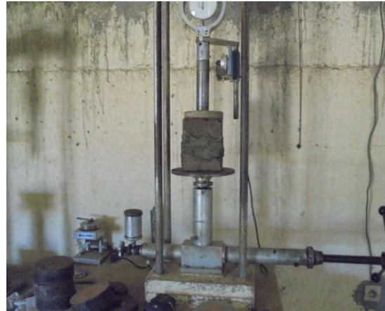
b : essai compression uni-axiale
