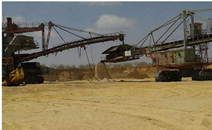
**Photo 4 :** *Décapage de la couche superficielle*
