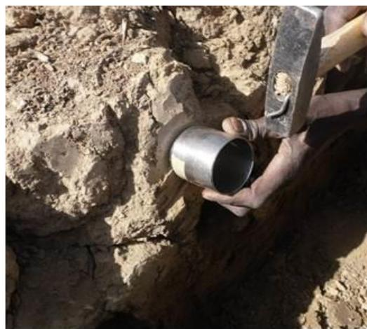
**Figure 2** : Prélèvement d'échantillon de sol non remanié à l'aide de cylindre
