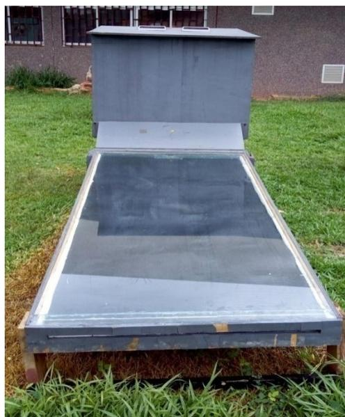
**Figure 1** : Photo du séchoir solaire indirect expérimental
