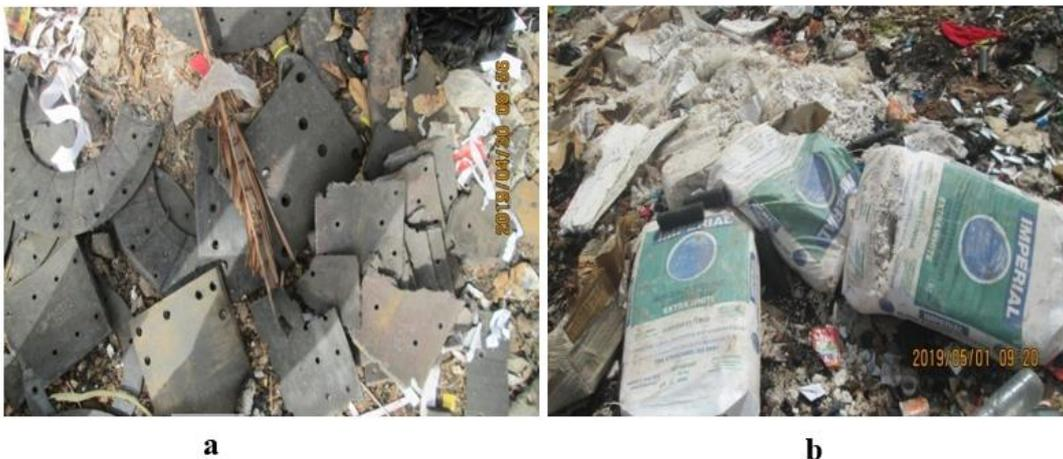
**Figure 7 :** Déchets associés aux amiantes : a) Plaquettes de frein ; b) Résidus de faux plafond (plâtre)
