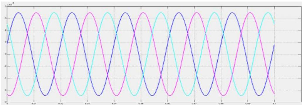
**Figure 6 :** *Courbes de tension charge compensation après filtrage*
