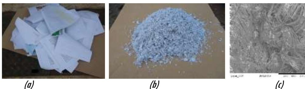
**Figure 1** : Images des déchets de papier (a), des granules de papier en vrac (b), des granules de papier vu au MEB (c)
