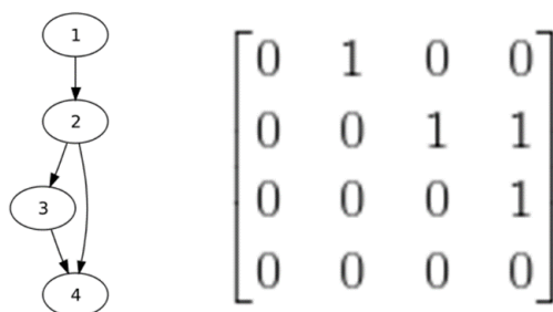
Figure 3 : Exemple de représentation d'un graphe orienté
