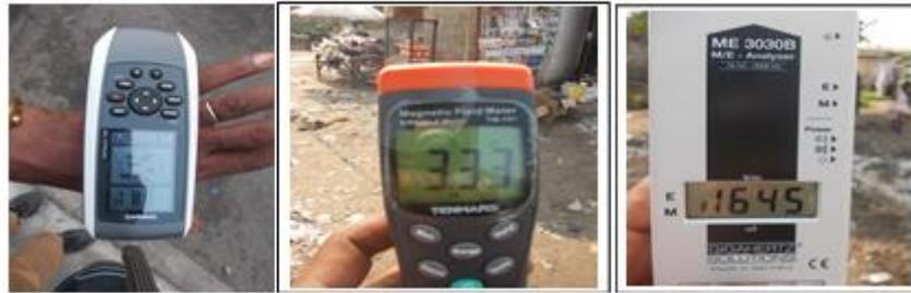
**Figure 2 :** De gauche à droite, le GPS MapGARMIN Série 78 Negro, l'analyseur de fréquences TENMARS et l'analyseur de fréquences GIGAHERTZ
