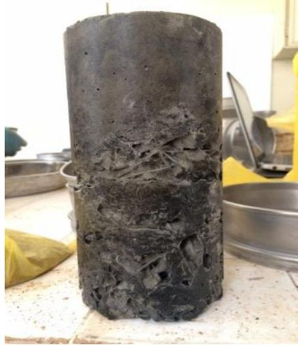
**Figure 2** : Béton de fibres poreux suite à un mauvais compactage
