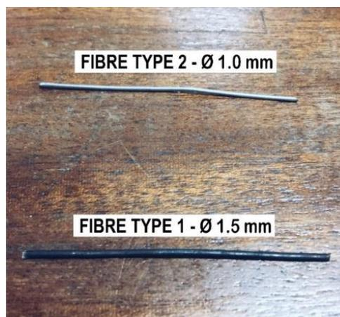
**Figure 1** : *Fibres métalliques utilisées*
