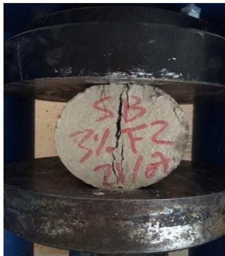
**Figure 4 :** Epreuve cylindrique placée dans le sens transversal
