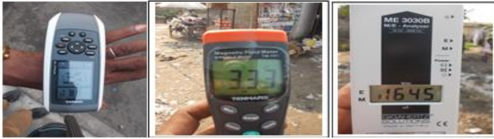
Figure 2 : De gauche à droite, le GPS MapGARMIN Série 78 Negro, l'analyseur de fréquences TENMARS et l'analyseur de fréquences GIGAHERTZ
