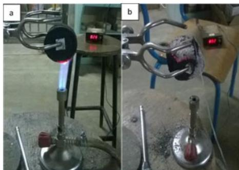
**Figure 2 : Test d'allumage (a) attaque de feu pendant 1s et (b) mesure du feu après l'attaque**
