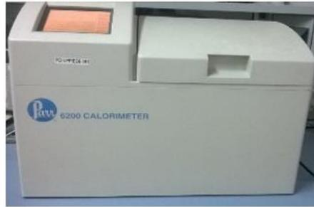
**Figure 1 : Calorimètre à bombe**
