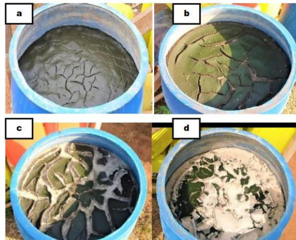
**Figure 10 :** Alimentation du lit de séchage ((a)4h (b) 12h (c) 24h et (d) 48h après l'alimentation)
