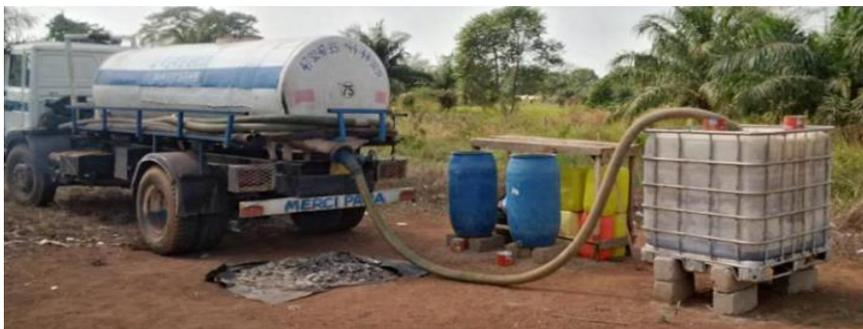
Figure 3 : Opération de remplissage du fût de stockage des boues de vidange
