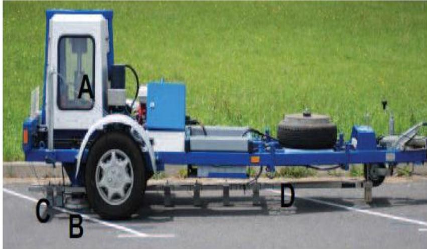
**Figure 1** : *Vue d'ensemble de la remorque FWD et de la poutre de mesure*
