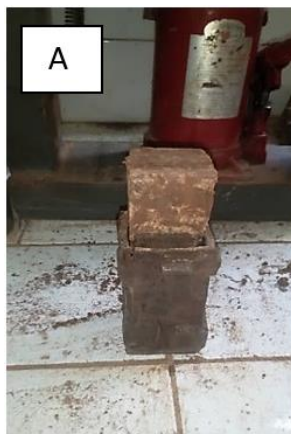
Figure 3 : Échantillons obtenus : (A) pour l'essai de résistance en compression et (B) pour les essais hygroscopiques et de résistance en flexion
