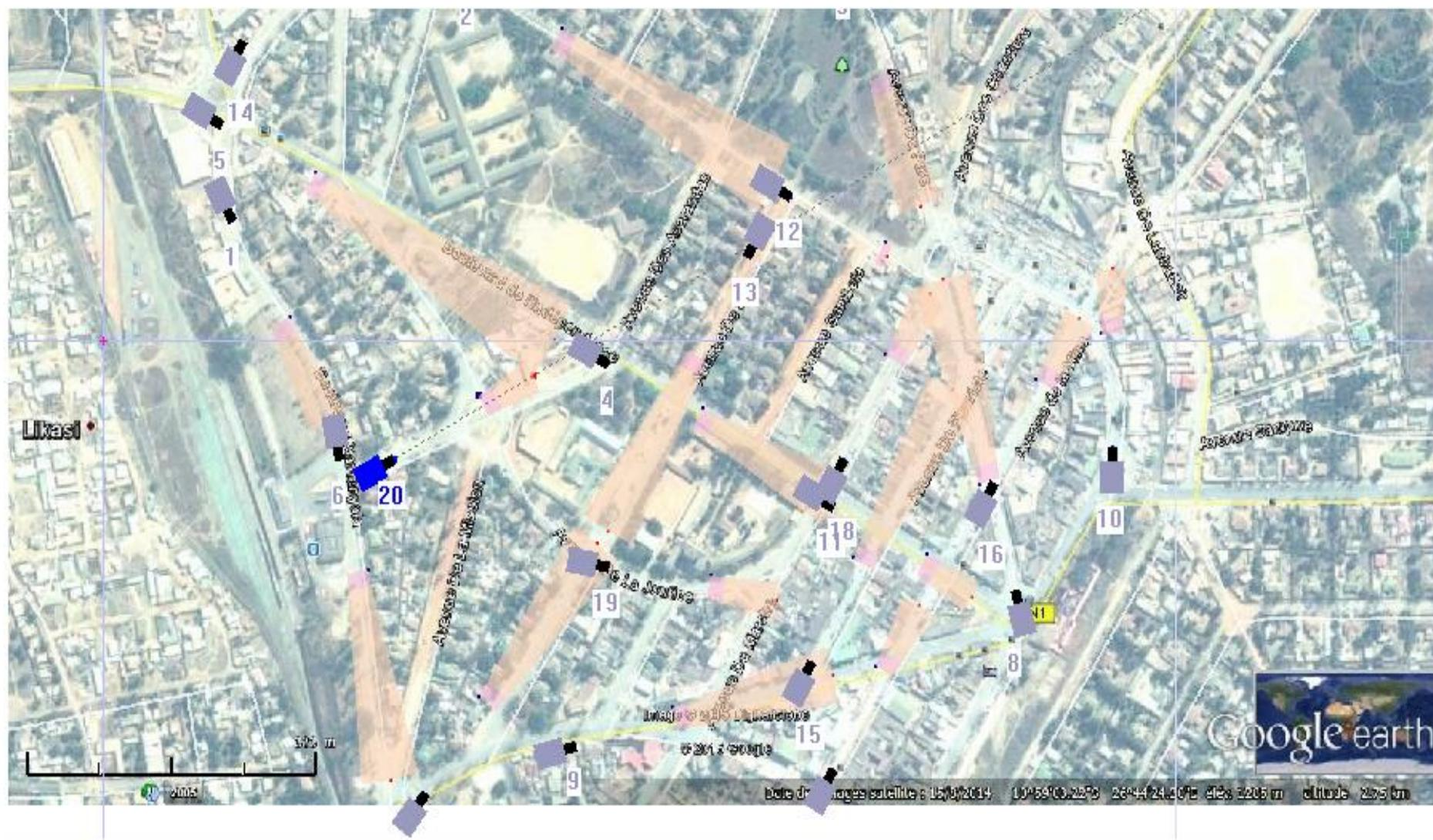
**Figure 1 : Installation des caméras des surveillances du centre-ville de Likasi**
