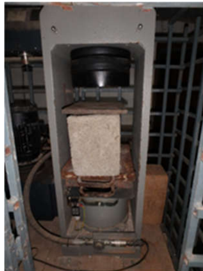
Figure 5 : Essai de résistance à la compression sur les parpaings
