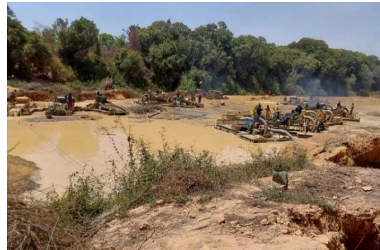
Photo 2 : Dragage semi mécanisé sur le Bagoé (Hanni KONE, 2026)
