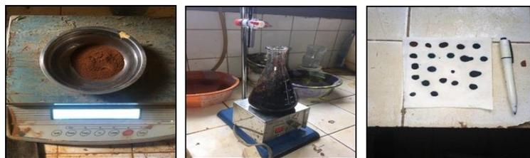
Figure 6 : Quelques étapes d'exécution de l'essai au bleu de méthylène
