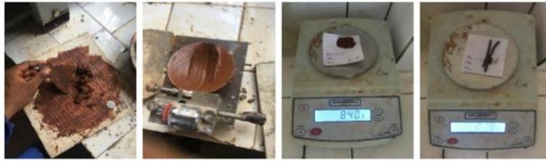
Figure 5 : Étapes de déroulement de l'essai d'Atterberg
