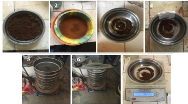
**Figure 7 :** Quelques étapes d'exécution de l'analyse granulométrique
