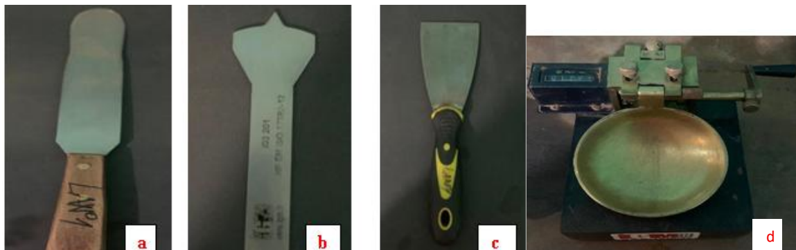
Figure 3 : Matériel essentiel pour la détermination des limites d'Atterberg
