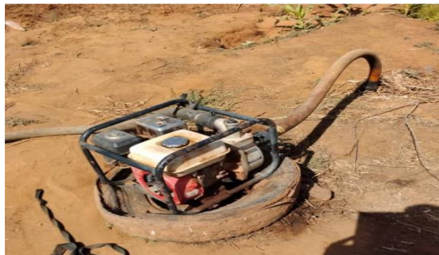
Figure 2 : Pompe à essence [10]
