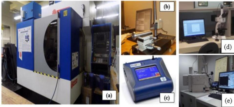
**Figure 1 :** *Equipement expérimental : a) Machine CNC, b) Rugosimètre SurfTest 301 Mitutoyo, c) Dust Track, d) Microscope optique, e) Microscope Electronique à balayage*
