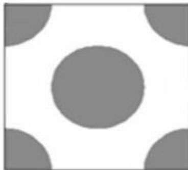
**Figure 1 : Géométrie périodique à simple porosité 2D**
