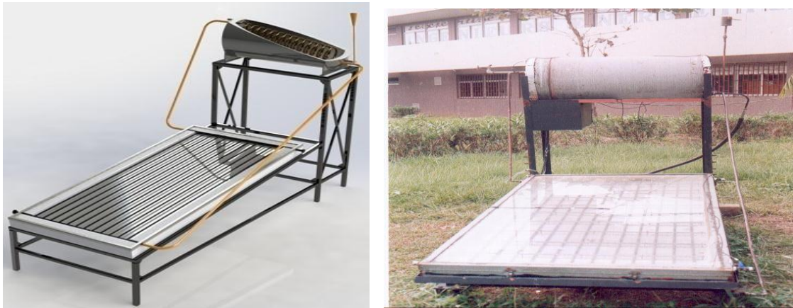
Figure 3 : Système de chauffe-eau solaire étudié et une présentation du réservoir de stockage avec l'échangeur de chaleur
