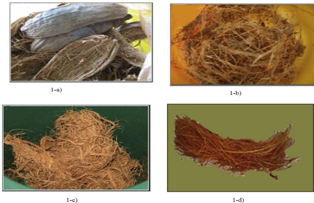
Figure 1 : Procédé d'extraction des fibres de coco (1-a), 1-b), 1-c)) et des fibres de coco utilisées dans les expériences comme matériaux isolants thermiques (1-d))
