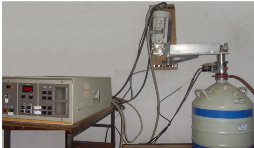
**Figure 6 :** Chaîne d'analyse par la spectrométrie de fluorescence X à réflexion classique [16]
