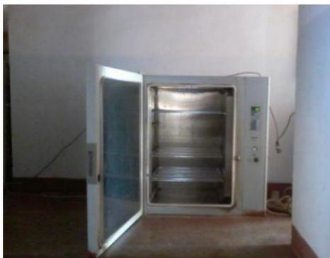
Figure 2 : Four électrique de marque SANYO [19]
