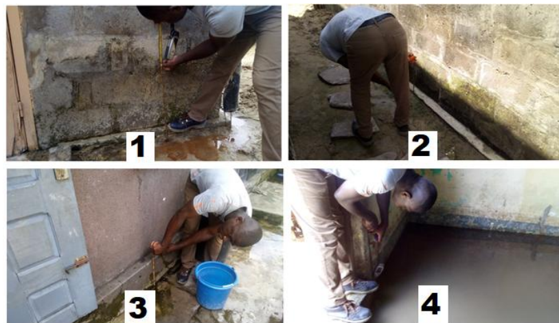
Figure 2 : Images des mesures des laisses-d'eau sur les murs des maisons à mikalou-madzouna ( P_1 et P_2 ) et Matari ( P_3 et P_4 ) ©: Etoua Douniama et Sitou, 2021
