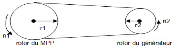
Figure 9 : Dispositif de transmission du mouvement circulaire
